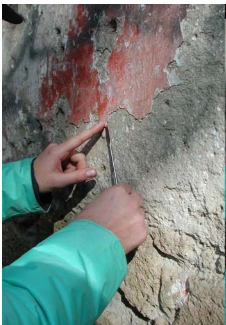
Figura 12 – Il prelievo delle campionature d'intonaco.
